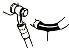
以目视检查是否泄漏或损伤，用扳手之类的工具，检查连接处是否松动，并且检查方向把手左右转动或行驶中的振动、管路保护部以外是否有其他零件接触干涉之虞。如有泄漏或损伤，请维修部检修。
