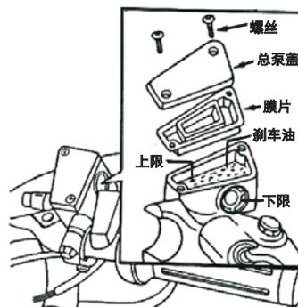
松开螺丝，再取总泵盖。清洁擦拭储存筒外周的杂物、污垢。但不要使异物掉入储存筒内。取膜片。补充刹车油至储存筒上限位置止。将膜片装上，并盖上总泵盖。注意膜片方向，勿让异物进入，并确实锁紧总泵盖。
